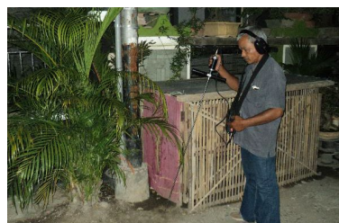
Pemeriksaan kebocoran air dengan alat sounding leak detection .
